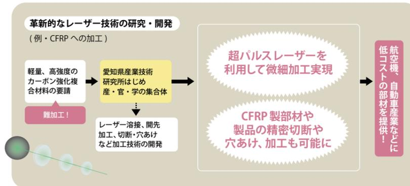
金属を瞬時に溶かさずに 5000 度以上に加熱し、プラズマ化して“衝撃波”とするには 1 億分の 1 秒という超短パルスのレーザー装置が必要だ。
