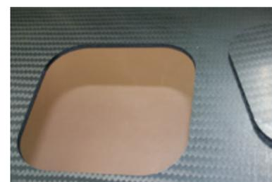
炭素繊維強化プラスチックにレーザーで穴を開ける。
