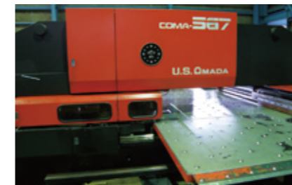
タレットパンチ（抜き打ち）加工機。
