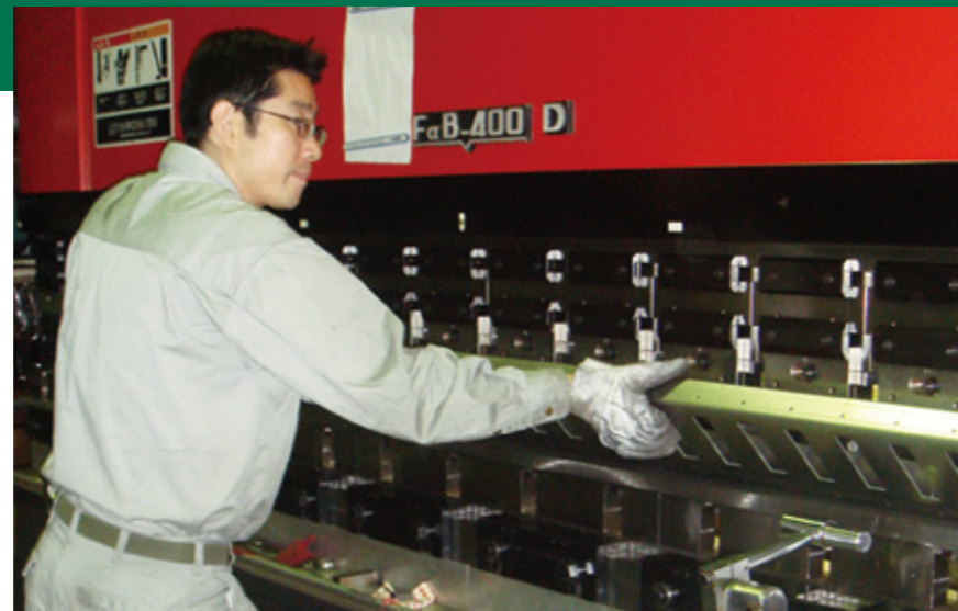
長尺曲げ加工（プレスブレーキ加工）のできる大型機。
